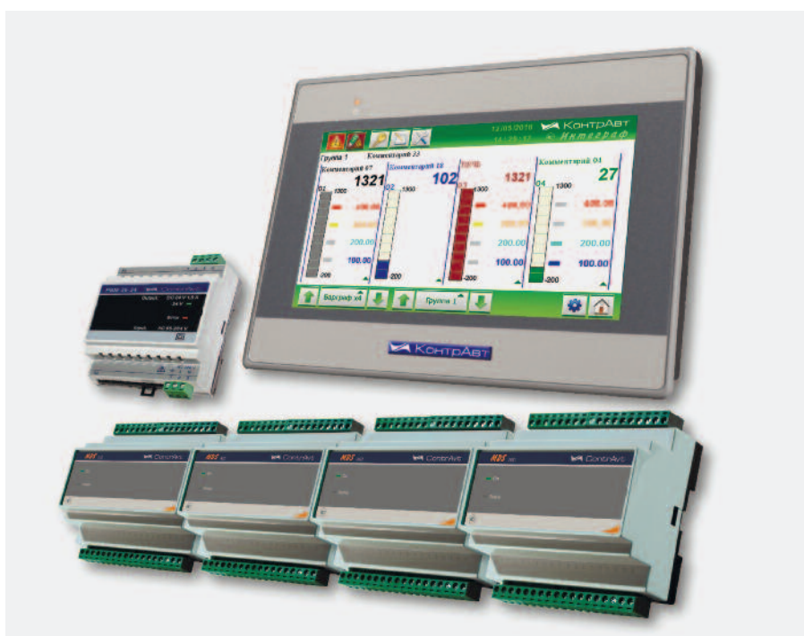
Рис. 1. Внешний вид видеографического регистратора ИНТЕГРАФ-1100
