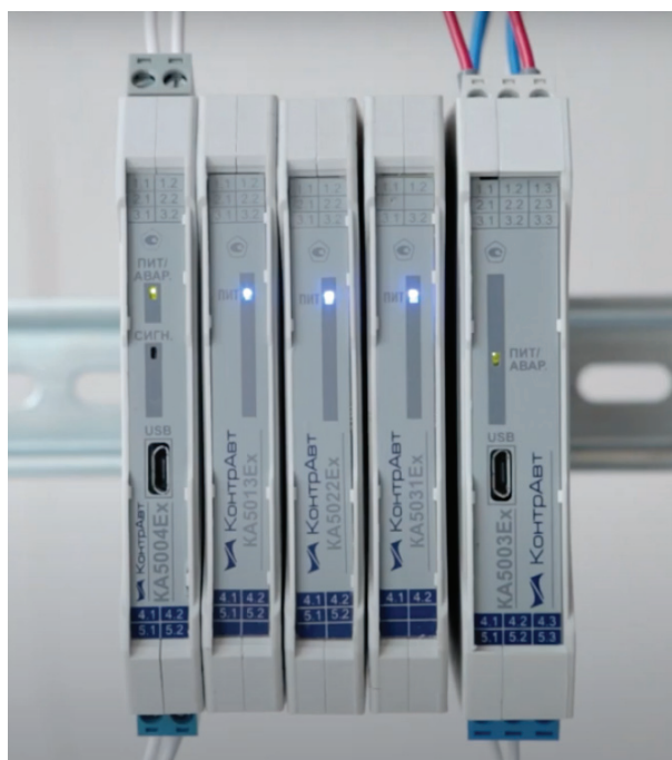
Рис. 4. Пример организации группового питания барьеров искрозащиты по шине
