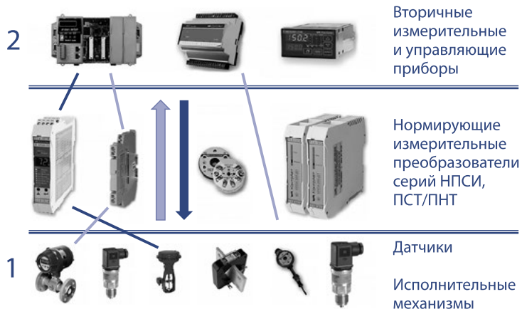
Рисунок 1 – Структура типовой системы автоматизации технологических процессов
